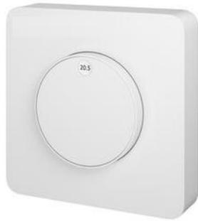
Die Raumthermostate F dienen der Temperaturregelung von Flächenheizungs- und –Kühlanlagen sowie von Heiz- und Kühldecken in Einfamilienhäusern, Mehrfamilienhäusern oder Wohnungen. Die Raumtemperatur wird über ein Ventil geregelt, welches von dem Raumthermostat über einen elektrothermischen Stellantrieb gesteuert wird. Erreicht die Raumtemperatur die Solltemperatur, wird das Ventil geschlossen.
